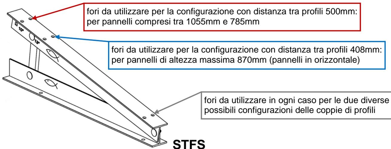
ATTENZIONE: nel caso di telai STFS inclinati a **13°**, se si vuole mantenere la sagoma dell'impianto entro i 30cm dal suolo, occorre limitare la massima altezza h di pannello fissabile in funzione dello spessore del modulo, come da tabella seguente (le altezze sotto riportate sono valide nell'ipotesi che il pannello sia montato con lo sbalzo massimo, pari a h/4, orientato verso terra):
